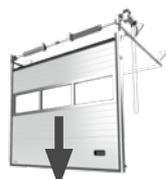
**C** – réduction des forces selon l'annexe A de la norme PN-EN 12453:2017 ou au moyen de dispositifs sensibles à la pression (PSPE ou ESPE).
